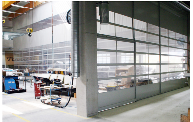
Rollbare oder dauerhaft angebrachte PVC-Vorhänge mit Sichtfenstern zur Trennung der Fertigungsbereiche für die Produktion.
